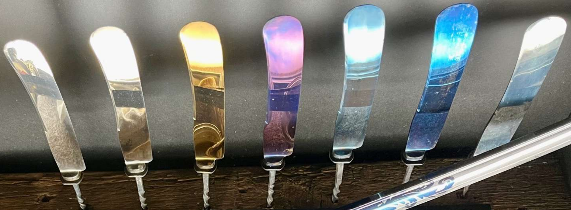
Pas d'exposition 220° 255° 277° 316° trop d'exposition Lames de coupeaux en acier poli
